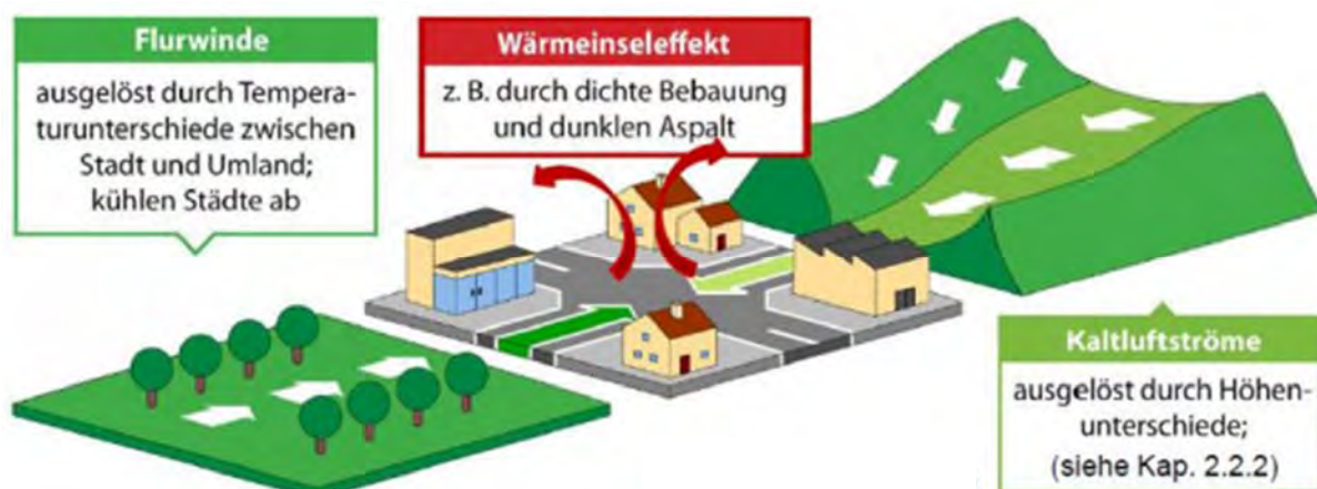
Abbildung 60 Schematische Darstellung von urbanen Wärmeinseleffekt, Flurwinden und orographischen Kaltluftströmungen (Quelle: BMVBS, 2013b, Abb. 5).
